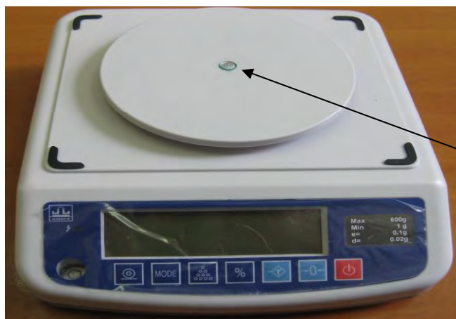
Рисунок 2 - Схема пломбирования от несанкционированного доступа и обозначение места для нанесения оттиска клейма.
