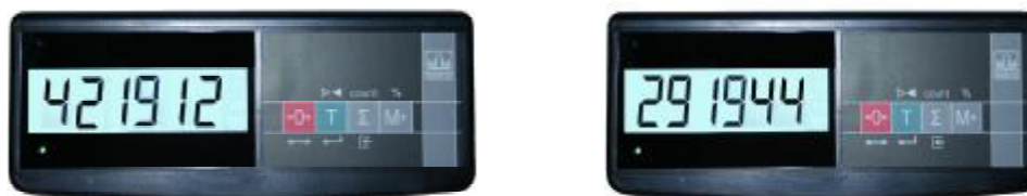
Рисунок 4 – Индикация кода юстировки
