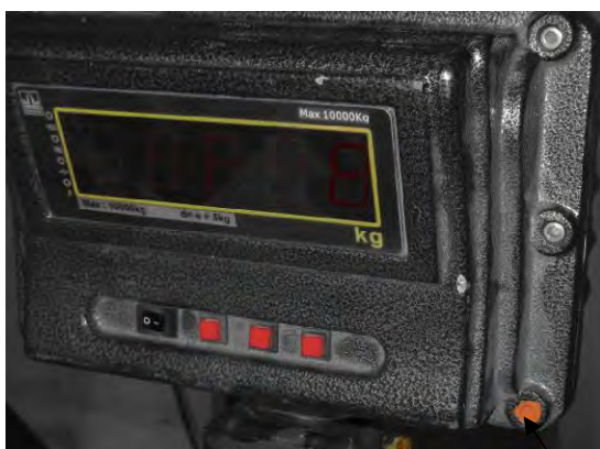
Место нанесения оттиска ательного клейма в весах ЕК-А
