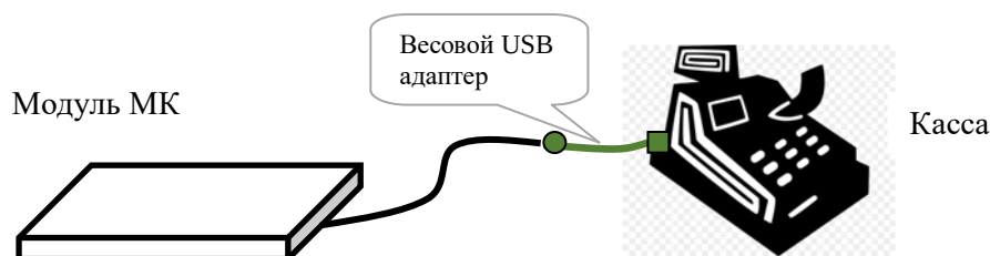
Рис. 6.6 Подключение модуля к кассовому оборудованию.
